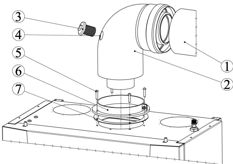
Рис. 6. Пример схемы подключения коаксиального дымохода к котлу
